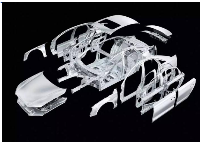
图 41：奥迪 A8L ASF 全铝合金车身结构
