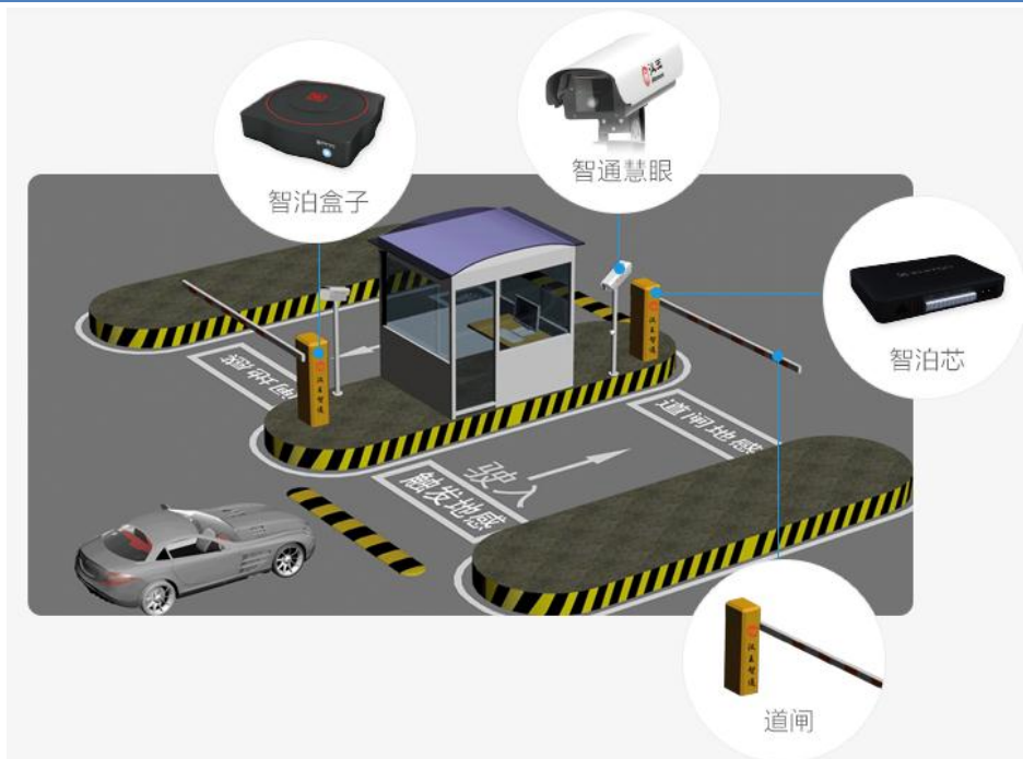
图 13：通通停车智能泊车系统硬件设施
