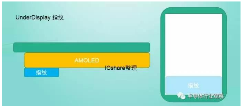
图49: Under Display方案将指纹识别芯片置于显示屏之下
