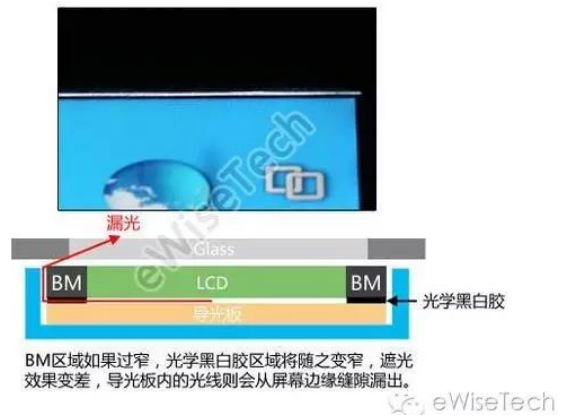
图12: BM区的作用是防止屏幕边缘漏光
