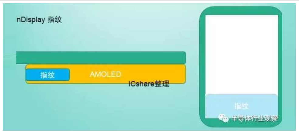
图57: In Display方案将指纹识别模组置于显示屏之内
