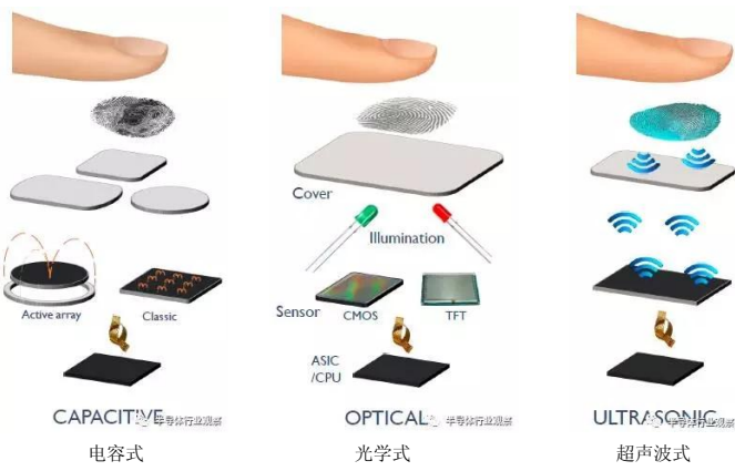
图50: 电容式、光学式和超声波式工作原理对比
