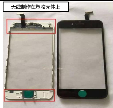
图72: 天线制作在塑胶壳体上
