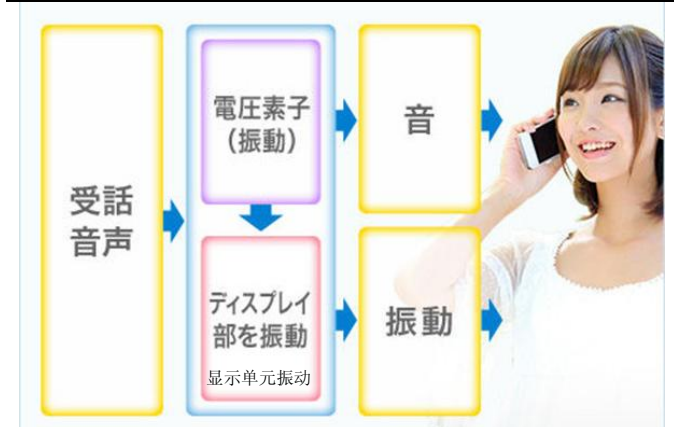
图78: 夏普的直线波接收器能够引起屏幕振动发声
