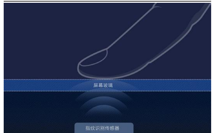
图46: 超声波方案可将指纹识别至于玻璃下方
