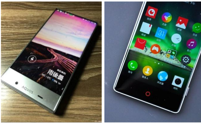
图21: 盖板玻璃边缘经过特殊加工处理
