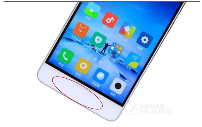
图48: 小米5s正面仍然有减薄挖孔，影响显示
