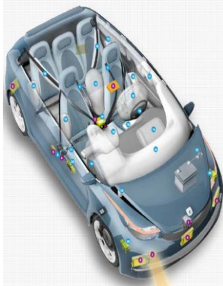
图 12：汽车的安全配件由安全带、气囊等构成
