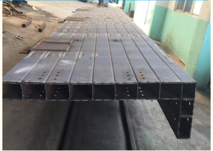
图表 4: L 型钢管束厚度小, 得房率高
