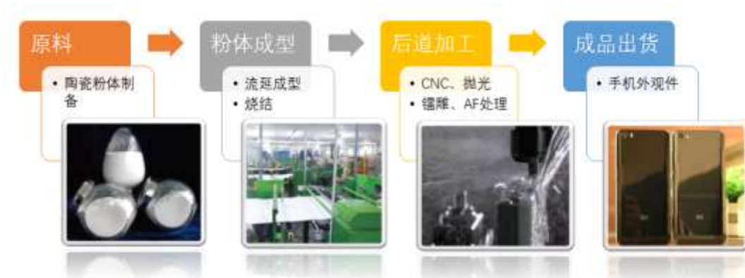
图 25：陶瓷机壳加工工序
