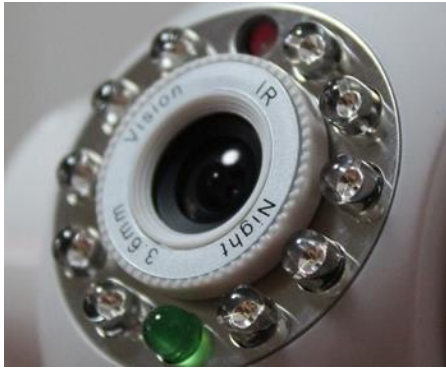
图表14: 夜视功能安防摄像头的 IR LED 光源示意图
