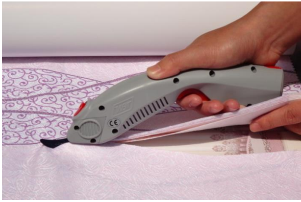
图 33：手工+电动裁刀效率低、精度低
