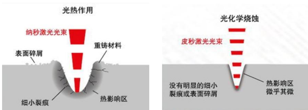
图 33：纳秒、皮秒激光光束对比
