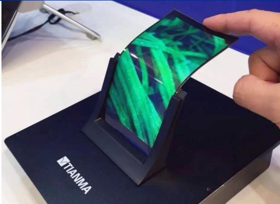
图 62: 天马 5.46 英寸 HD 柔性 AMOLED 显示屏曲率半径达 20mm
