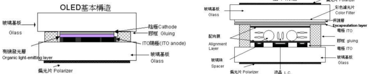
图 13: OLED 与 TFT-LCD 基本构造对比
