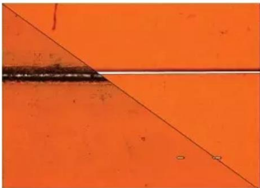
图表 14：使用 CO2 激光器(图左) 和紫外激光器(图右)对聚酰亚胺进行切割
