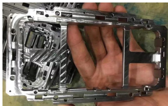
图表 12：中框需要紫外激光进行 PVD 等微加工
