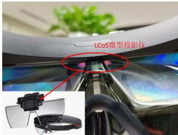
图表 19: HoloLens 上投影仪所在
