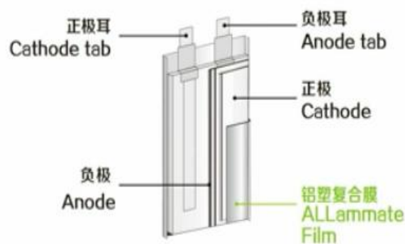
图 9: 软包电池结构
