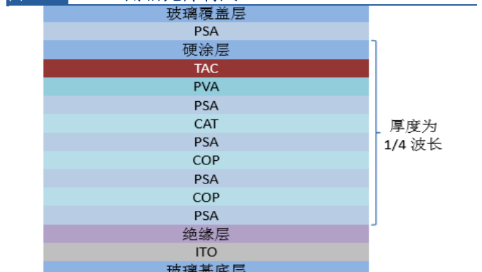
图 28: OLED 用偏光片构成
