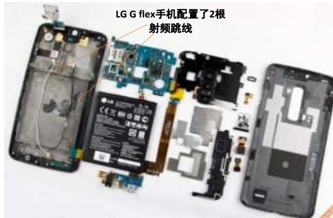
图 4:从手机拆解图看射频跳线情况
