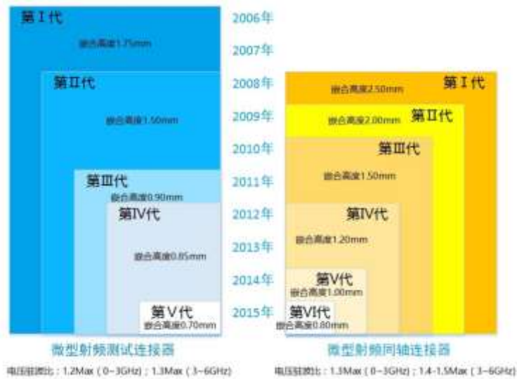
图 5:手机射频连接器的嵌合高度逐代缩小
