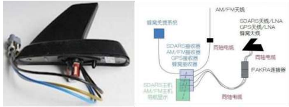
图 11:汽车顶部的天线需要使用多根 fakra 连接器及线缆组件
