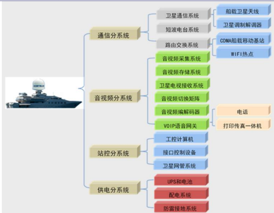
图表 25：船载宽带卫星通信系统
