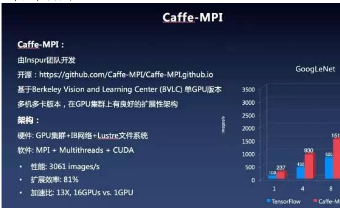
图 2：深度学习训练框架软件层面：公司开发的 Caffe-MPI 每秒处理图片数量是同配置集群运行的谷歌训练框架 TensorFlow 1.0 的近 2 倍
