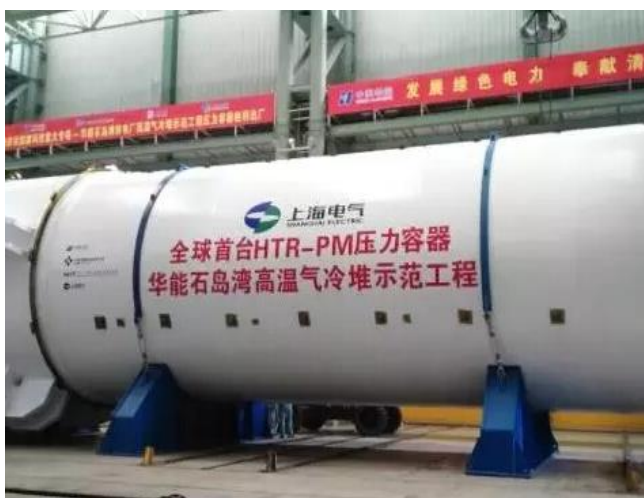
图 5：公司自主研发的全球首台高温气冷堆压力容器
