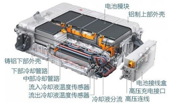
图 5：电池冷却系统工作原理
