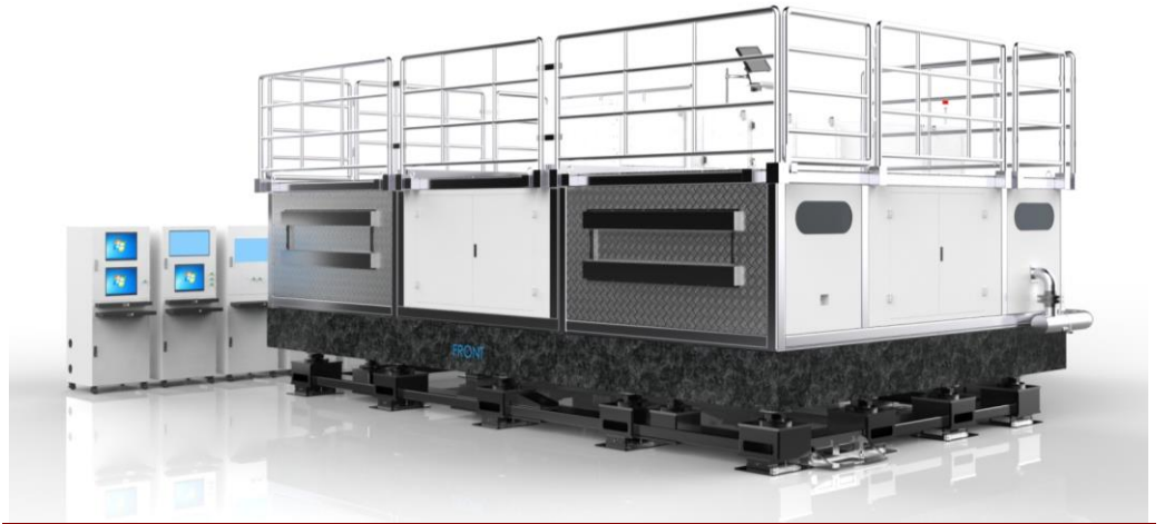
图 63: 国内首台柔性 AMOLED 激光剥离设备
