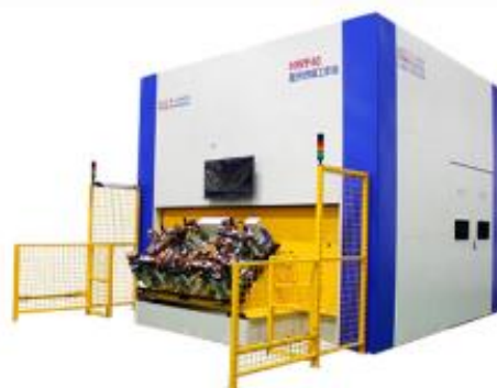
图 95：汽车车身覆盖件激光焊接工作站
