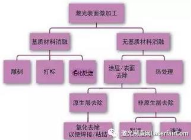
图 27：激光表面微加工技术分类
