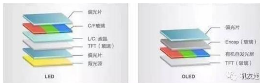
图表 1: OLED 相对于 LCD 结构更为简洁
