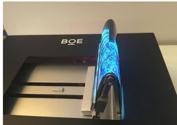
图表23：京东方 0.23mm AMOLED 显示屏示意图
