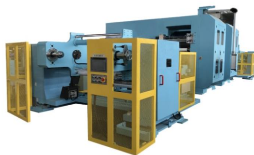
图 14：高速双辊辊压系统
