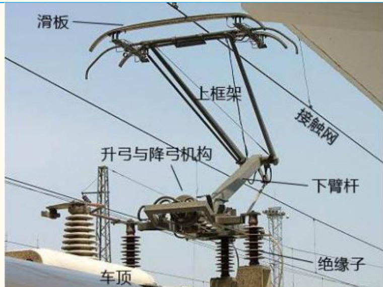
图表 22: 受电弓构成示意图
