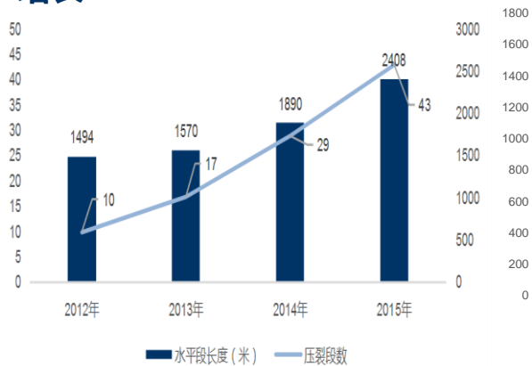
图：Chesapeake公司Utica盆地水平井平均长度和压裂段数同比大幅增长
