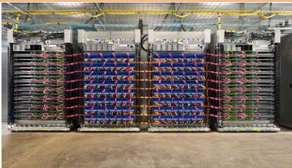
图 24：TPU Pod，由 64 台 TPU 组成，算力达 11.5 petaflops
