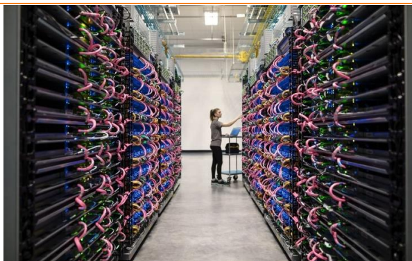
图 10：TPU Pod 由 64 台第二代 TPU 组成
