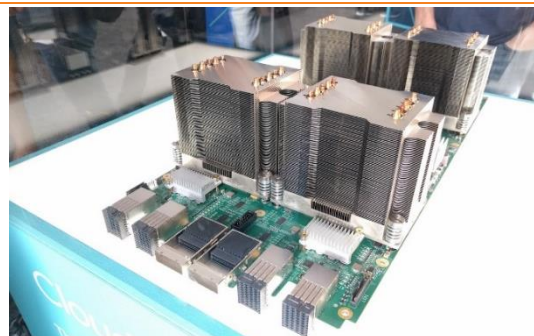
图 23：第二代 TPU 包含 4 个芯片
