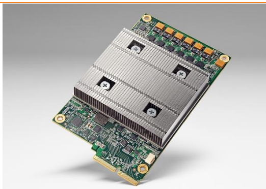
图 5：谷歌第一代 TPU 电路板
