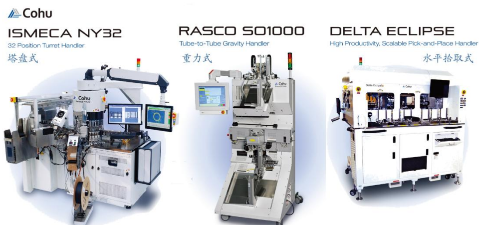
图34 分选机常见的三种结构类型
