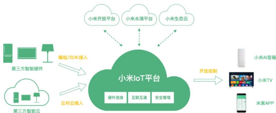
图 3：小米 IoT 平台实现智能硬件彼此间的互联互通
