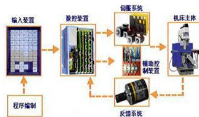
图 9：伺服系统是数控机床提高加工质量和生产效率的关键
