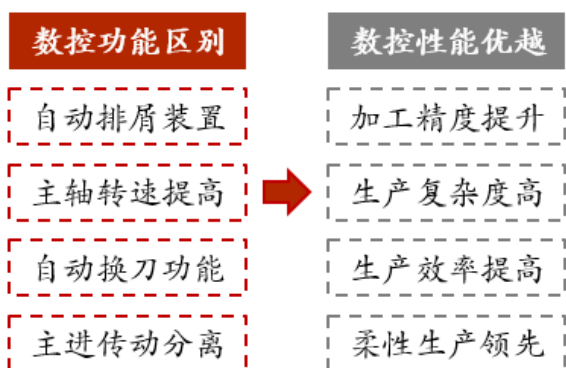
图 19：数控机床与普通机床功能和性能区别
