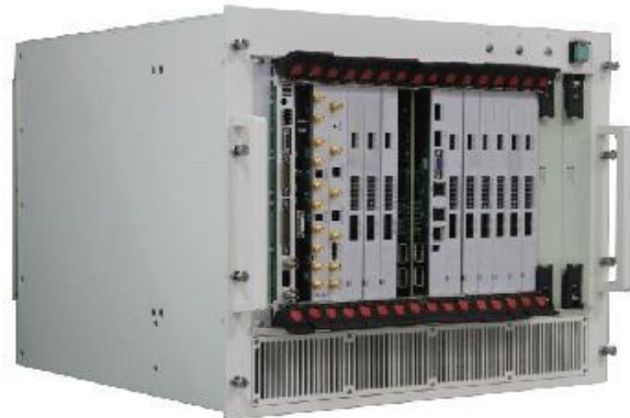
图表 52：VPX 系统产品示例
