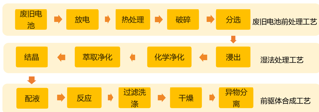
图 35：CATL 废旧电池回收及再利用工艺流程
