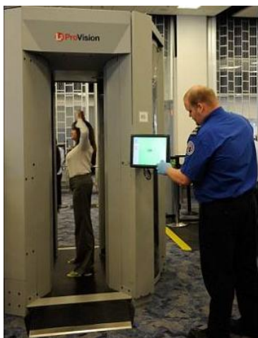
图 10：欧美机场已开始应用太赫兹人体安检产品
