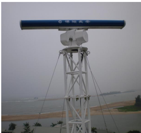
图 9：博微长安生产的船舶监视雷达
