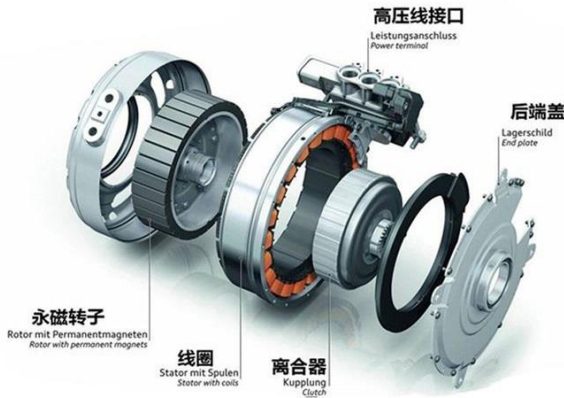
图 29：永磁同步电机示意图
