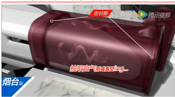
图表8：“海底真空高铁”构想真空形成示意图
