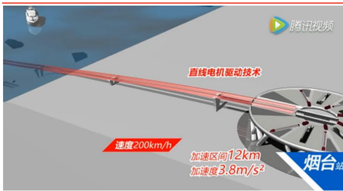
图表6：“海底真空高铁”构想的驱动技术示意图
