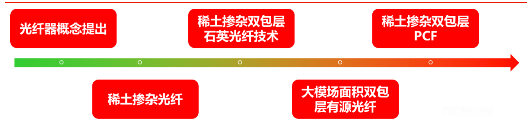
图表3：光纤激光器用特种光纤技术演变图
