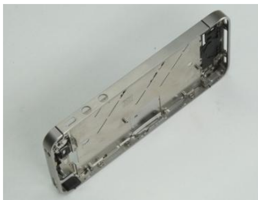
图 34: iPhone 4 不锈钢边框结构复杂、加工精度高
