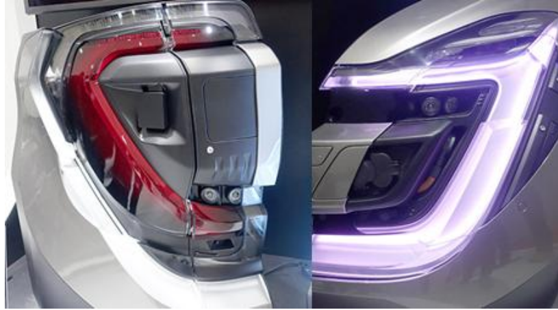
图表14：马瑞利“Smart Corner”车灯-传感器整合方案
