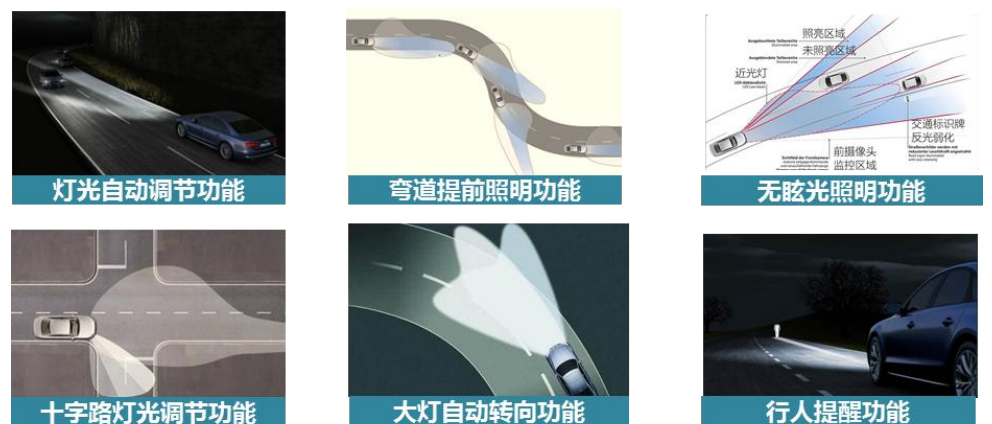
图表13：奥迪矩阵式大灯能实现多种智能化功能
