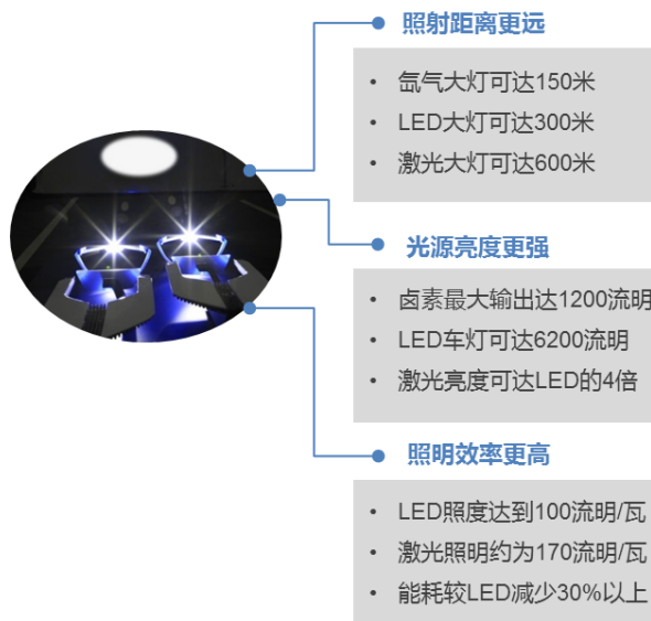
图表9： 激光大灯是下一代汽车照明新技术
