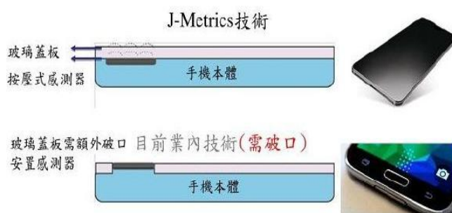
图 10：茂丞科技基于射频技术的屏下指纹识别方案
