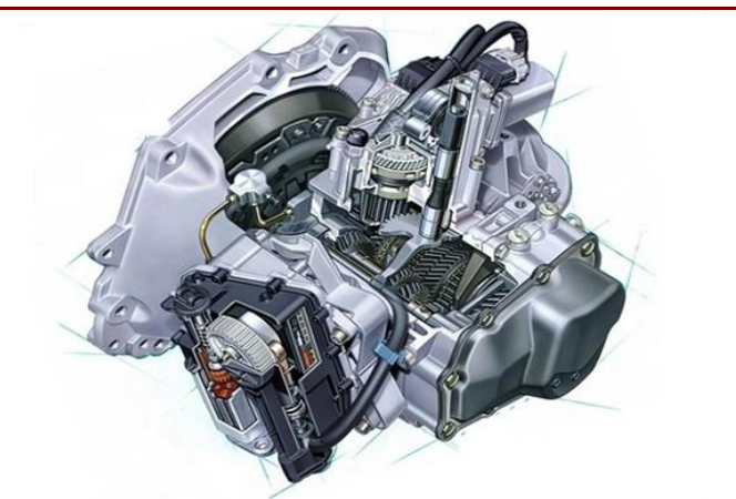
图 53: AMT 自动变速箱结构
