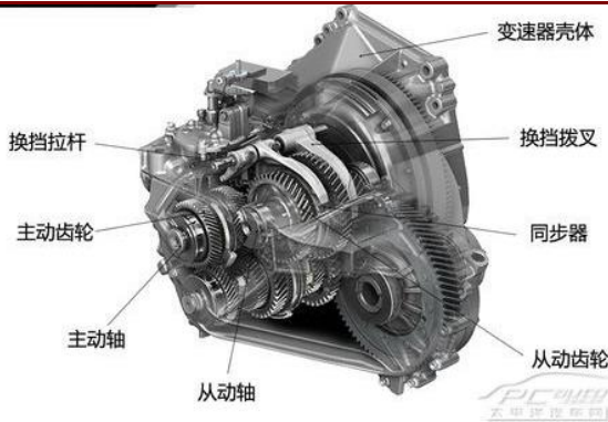
图 49: 手动变速箱结构图
