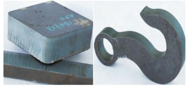
图 42：船舶工业制造中 4 kW CO 2 激光器切割效果
