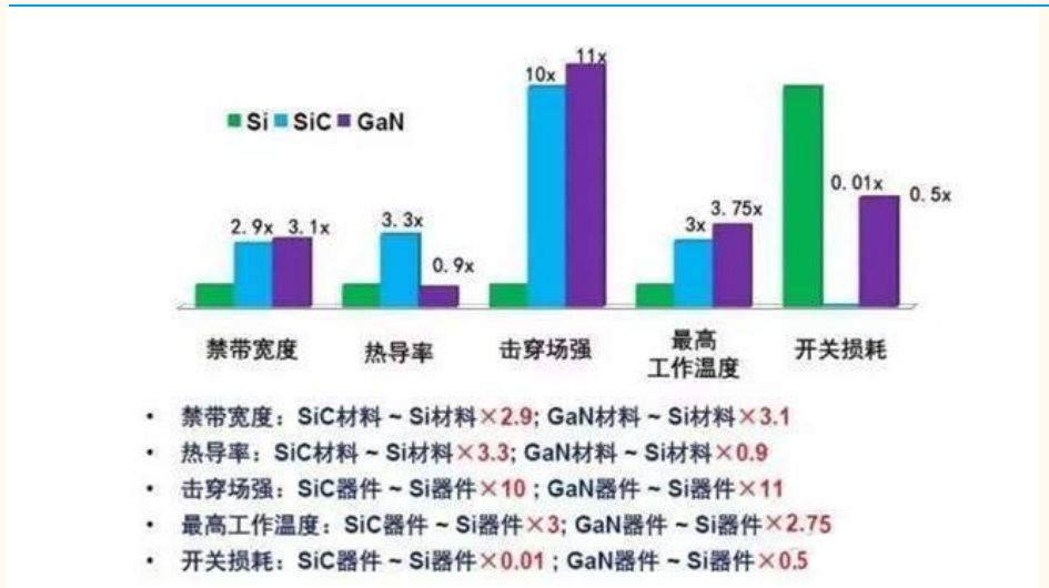
图表 1：第一代半导体 Si 和第三代半导体 SiC、GaN 性能对比
