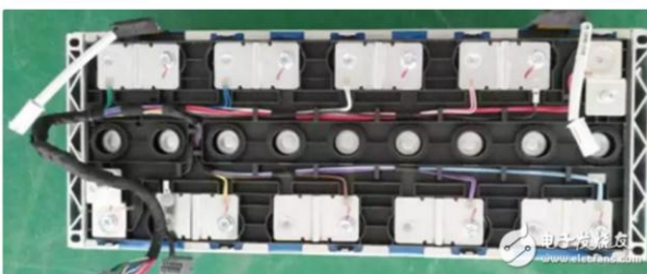
图 22: 过去, MCU 通过导线连接采样点
