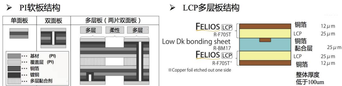
图 47：PI 软板与 LCP 软板的剖面结构
