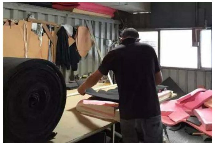
图表 23: 海绵切割、拼接
