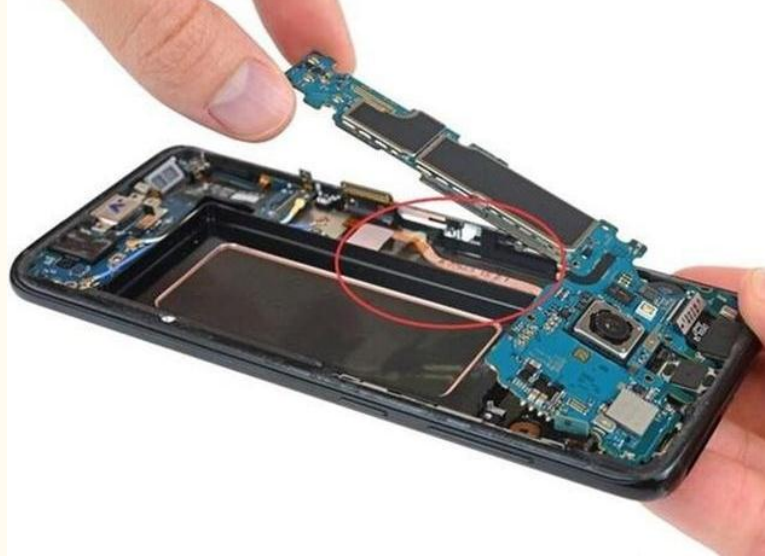
图表 17: 三星 S8 液冷热管散热技术
