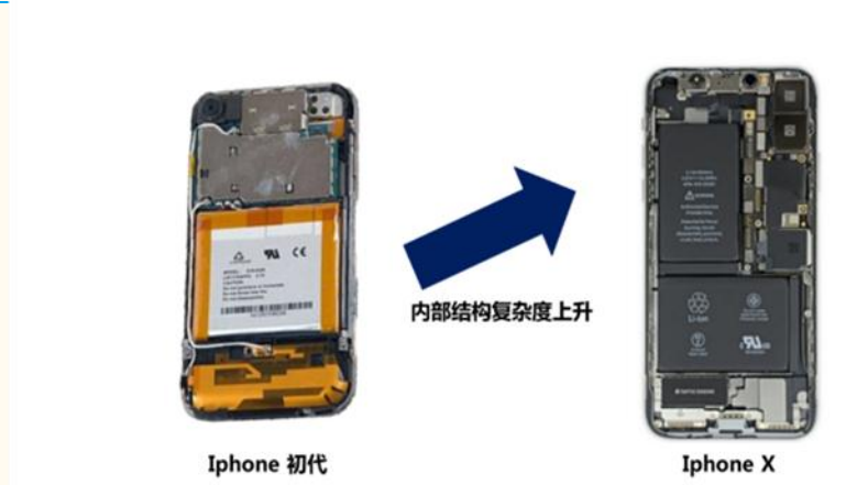
图表 24: 手机内部复杂度提升，对天线集成度要求提高
