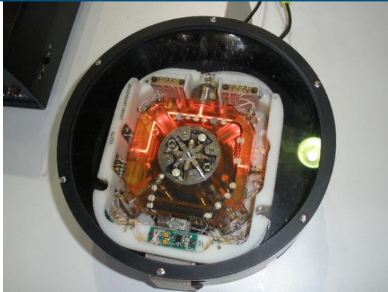
图 13：环形激光陀螺仪
