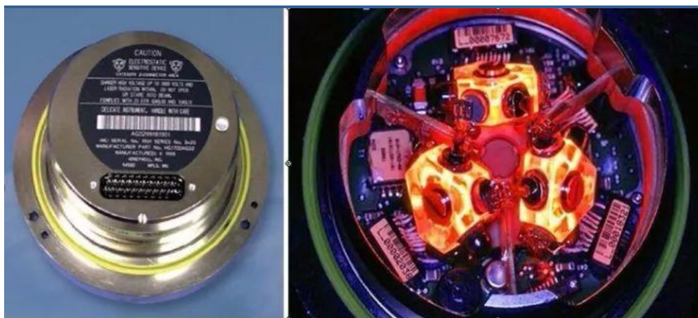
图 25：霍尼韦尔公司 HGI700 IMU 及其内部的三个 GG1308 陀螺仪
