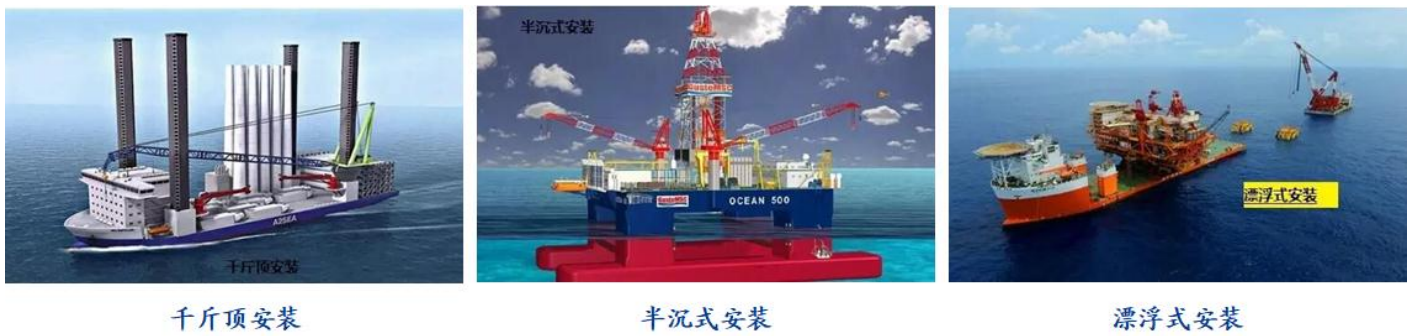
图表 8 海上风电常见的 3 种安装方式
