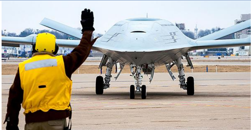
图表 28: 波音为 MQ-25A 隐身舰载无人加油机方案研制的样机
