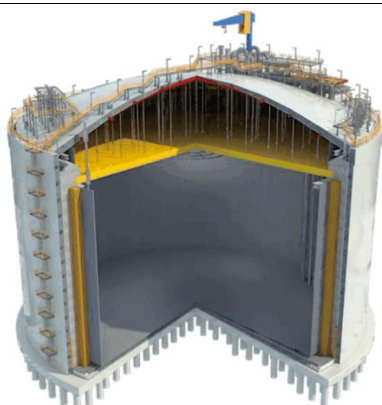
图 89: LNG 全容储罐结构
