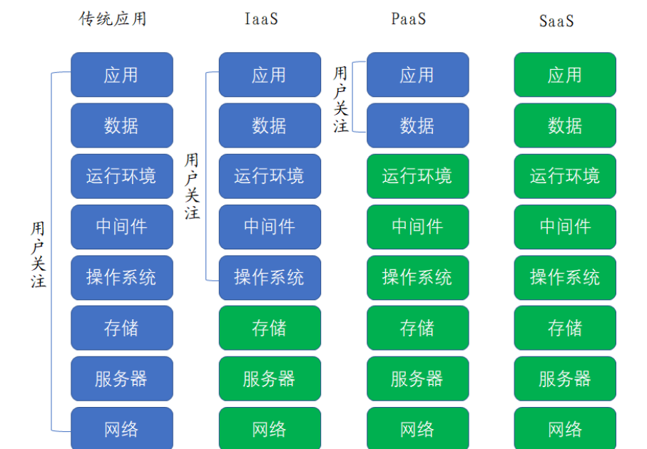
图 1: IaaS 提供存储、服务器、网络等底层硬件资源
