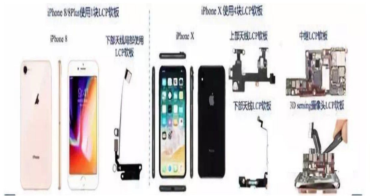
图表 17: 苹果 X 使用 LCP 软板具体情形
