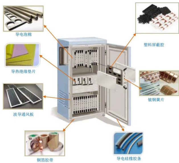
图表 56：电磁屏蔽和导热产品在通信机柜中应用
