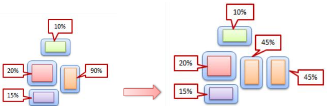
图 10：微服务架构具备水平扩展、弹性伸缩能力
