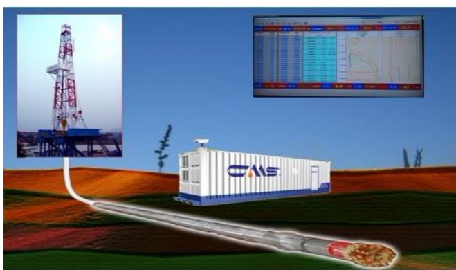
图表 15：随钻录井仪器示意图
